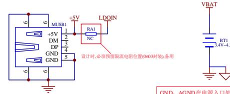
GND、AGND在电源入口处短接在一起!
